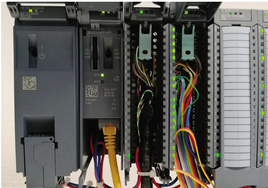
Bild 3.3 S7-1500 «intern», von links nach rechts: Netzteil, S7-1500, Baugruppen DI und DO, mit geöffneten Abdeckungen
