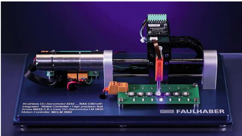
Abb. 1.1 FAULHABER-Demonstrator eines Pick & Place-Systems mit kompakter Lineareinheit und BLDC-Linearmotor
