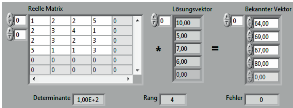
Bild 1.24 FP „lgs.vi“ – Lösung eines linearen Gleichungssystems
