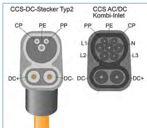
Bild 5.11 CCS Typ 2 Ladestecker PI-Belegung (Bild: Schmidt)
