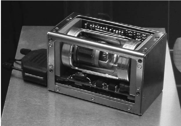
Bild 1.3 Atomuhr, wie sie in einem GPS-Satelliten eingesetzt wird
