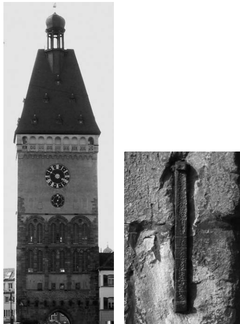
Bild 1.1 Stadttor in Speyer, das Altpörtel. An der nördlichen Seite der Durchfahrt kann man noch heute den «Speyrer Normalschuh» (Messnormal von 1773 in Form einer eisernen Klammer, 28,889 \text{ cm} hoch) besichtigen.
