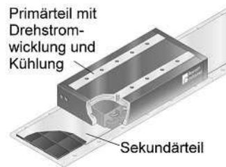
Bild 2.8 Linearantrieb Rexroth/Foto + Detail: (Quelle: Indramat)
