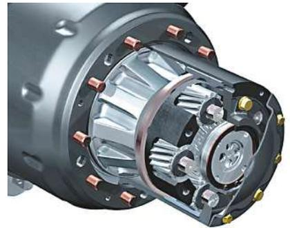
**Bild 1.35** Teil einer Außenplanetenachse
