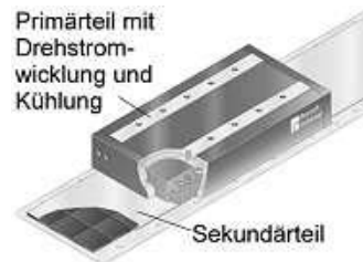
Bild 2.8 Linearantrieb Rexroth/Foto + Detail: [Quelle: Indramat]
