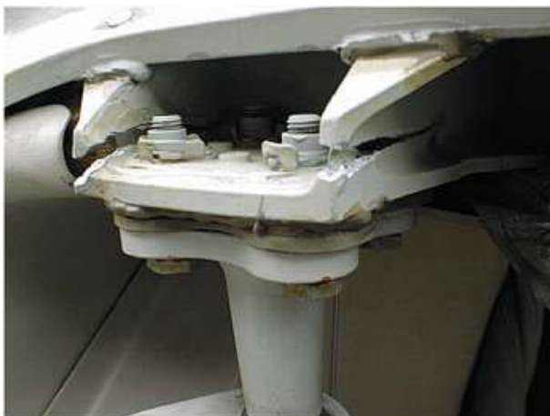
Bild 2.4 Ermüdungsbruch: Aufhängung Kabinentür, Kurbelwelle
