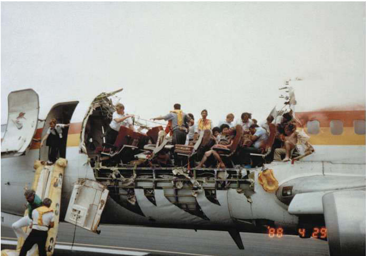
Bild 2.5 Aloha Airlines: Materielle Ermüdung der Zelle
