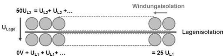
Bild 2.4 Isolationsspannungen
