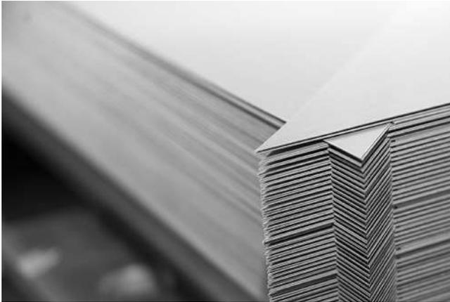
Bild 2.2a Stoßstelle eines Trafokerns in Step-Lap-Technik
