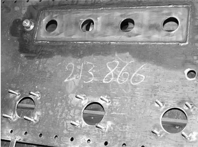
Bild 2.9 Kesseldeckel mit Edelstahleinlage
