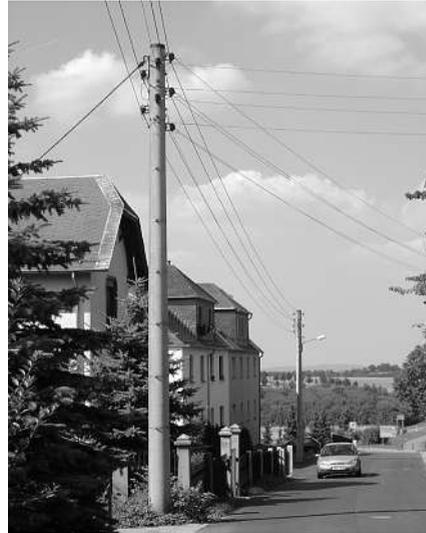
Bild 1.8 Niederspannungs-Freileitung (Netzebene 7)
