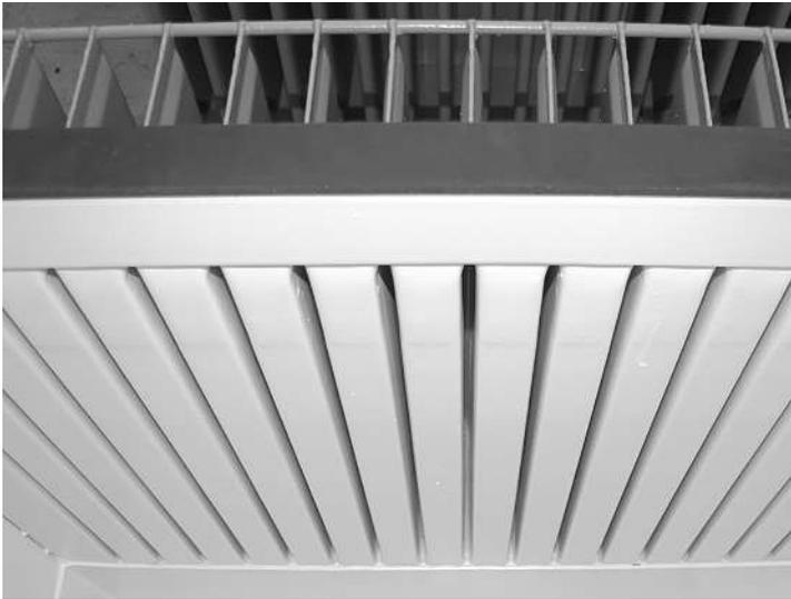
Bild 2.6 Faltwellenkessel
