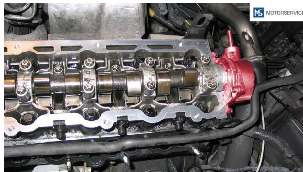
Bild 1.5 Beispiel für eine Vakuumpumpe mit Nockenwellenan- trieb (rotes Gehäuse), eingebaut im Vectra B [Bild: Rheinmetall]
