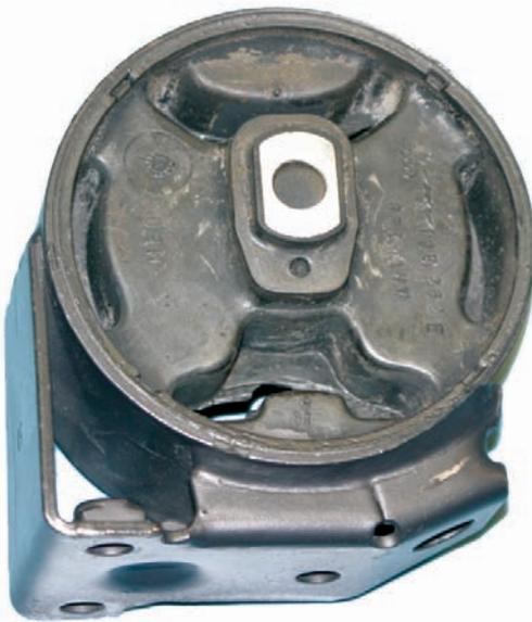
**Bild 2-1.** Motorlager eines Volkswagen Golf II, Baujahr 1985.
